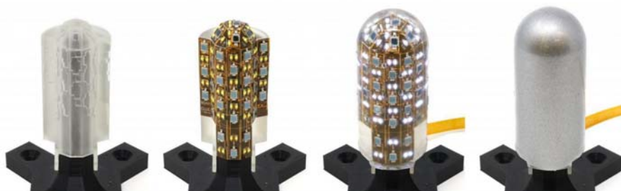
Рис. 5. Первый роботизированный палец нового поколения
