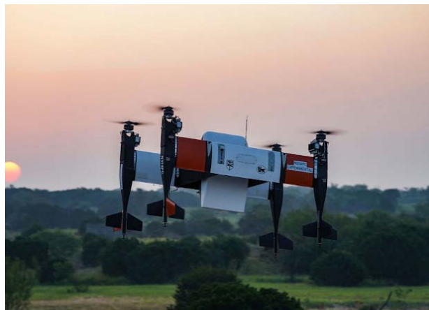
Рис. 3. БПЛА ART 70 со схемой взлета типа «тейлситтер»
